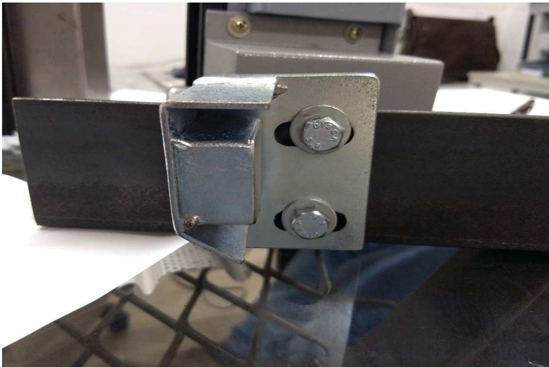
Figura 1: Travas com sistema oblongo.
